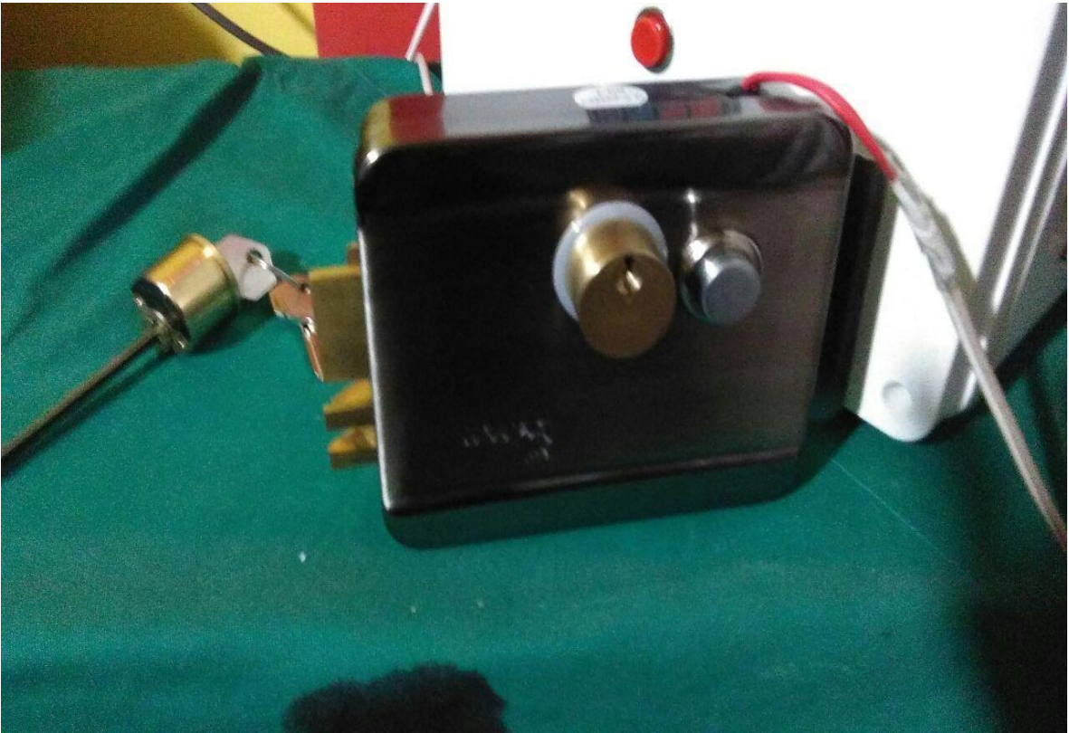
Figura 66. Aplicaremos de puerta automática en Sistema Domótica.
