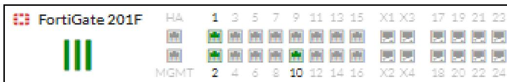
El puerto 1 LAN del firewall se utilizará para tener comunicación con el switch Core, la misma que permitirá enrutar el tráfico para salida hacia internet a todos los usuarios de la Institución, la IP a configurar será la siguiente: 172.17.1.1/24.
