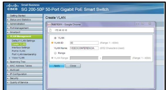
Figura 57. Configuración del Switch- vlan 40
