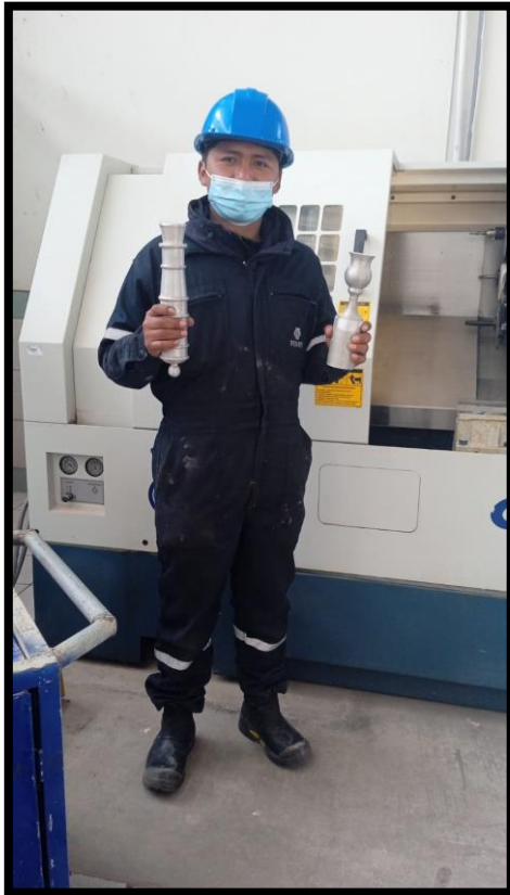
Diferentes piezas mecanizadas en torno CNC con software Mach3
