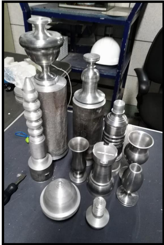
Diferentes piezas mecanizadas en torno CNC con software Mach3
