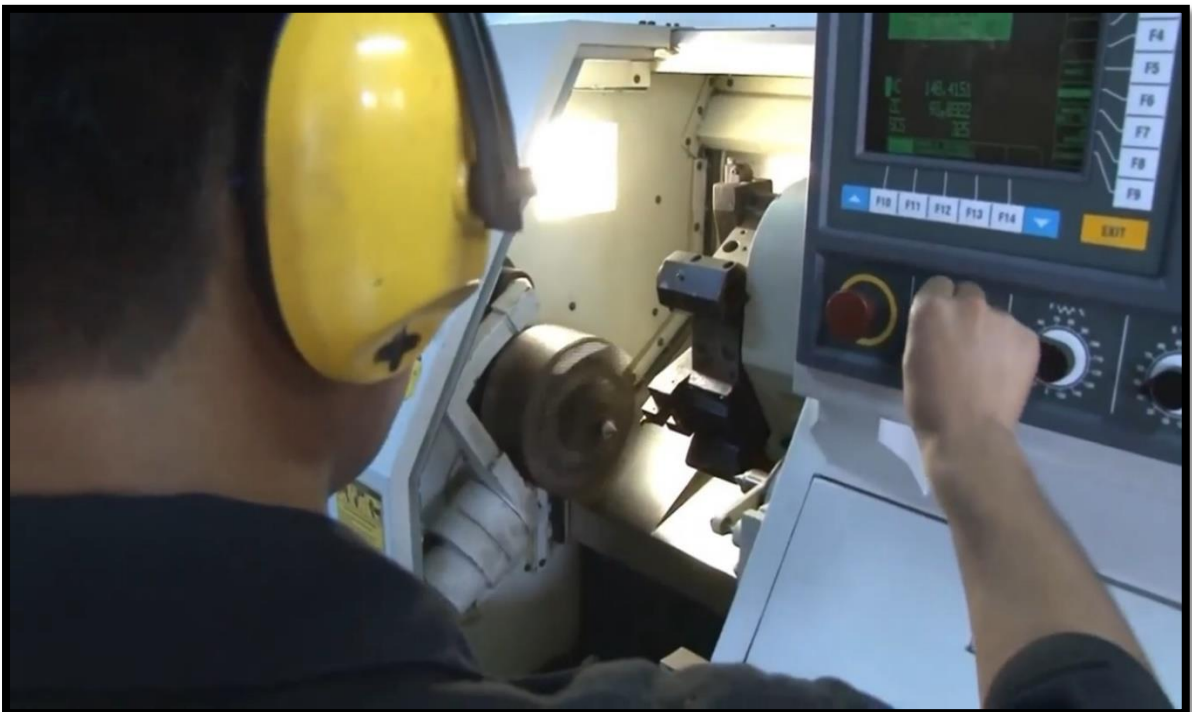
Poniendo en cero máquina al torno CNC
